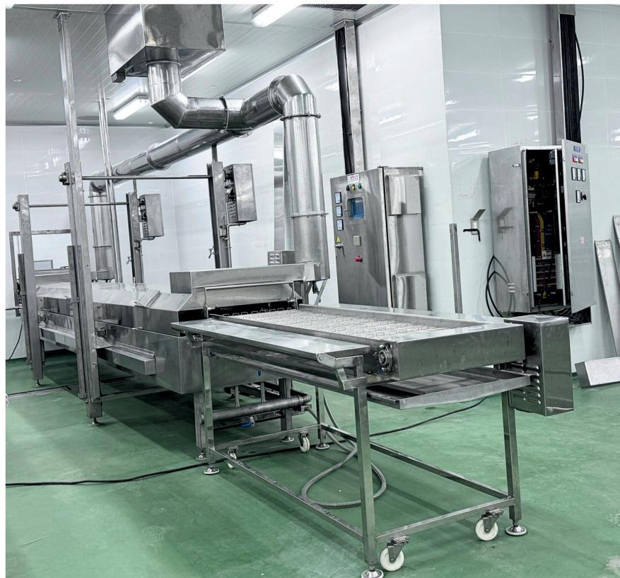
Hệ thống chiên băng tải là thiết bị chiên đa dạng sản phẩm với công suất lớn, thiết kế tích hợp với bộ lọc dầu tinh loại bỏ tạp chất trong dầu chiên, kéo dài tuổi thọ dầu chiên, tiết kiệm lượng dầu chiên, tối ưu chi phí sản xuất . Nhiệt độ dầu ổn định dao động từ 0.5 đến 1 độ C giúp sản phẩm chín đều và đẹp.
